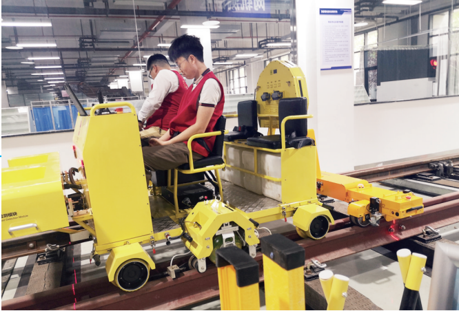
智能巡检机器人演示。
