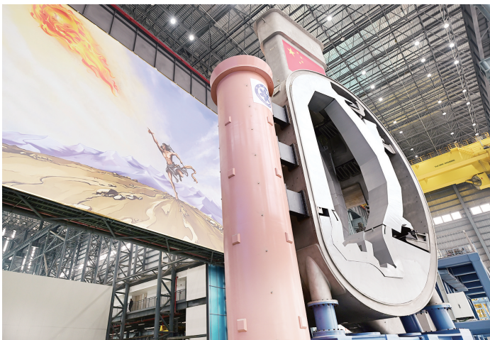
3月9日拍摄的聚变堆主机关键系统综合研究设施八分之一真空室及总体安装系统主体平台。 新华社记者 周牧 摄
