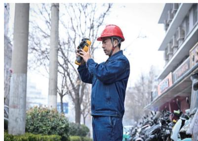
王佳飞在城三线使用红外测温仪进行带电检测工作。
