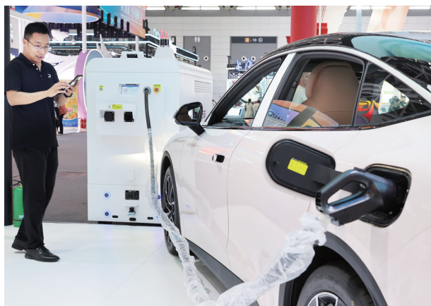
无人驾驶智能移动充电车为电动车充电。
