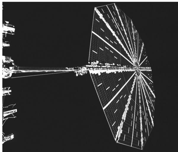
6月6日,国家航天局发布天问二号探测器传回的圆形太阳翼展开的图片。为满足在距离太阳约3.75亿千米的主带彗星开展探测的供电需求,天问二号探测器研发配置了圆形柔性太阳翼。
