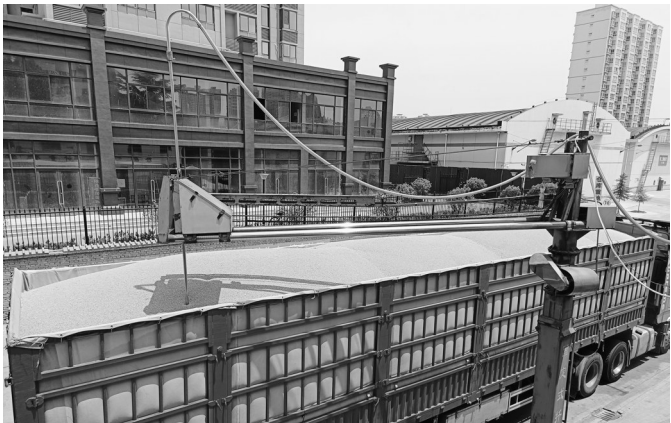
全自动扦样机正在车厢里采集小麦样品。 本报记者 马昭摄
