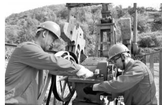
3月27日,在南泥湾采油厂新窑采油队新306井场,工人白景朝和尹虎正在进行抽油机一级保养,紧固各部件螺丝,检查机械油润滑、调整、清洁、防腐工作。潘燕华摄
