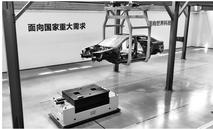
合装机器人已经广泛应用于汽车制造领域
