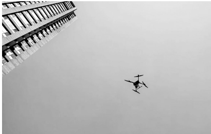
无人机在楼外隔窗检测室内燃气浓度。
