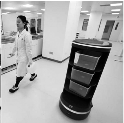
用气动物流系统和机器人收发标本。
